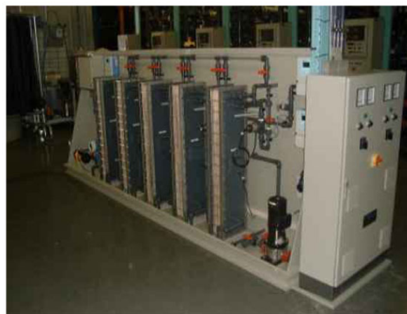
شکل ۱۲- فرایند جداسازی الکترودیالیز
