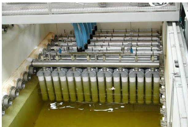
شکل ۱۱- فرایند جداسازی میکروفیلتراسیون
